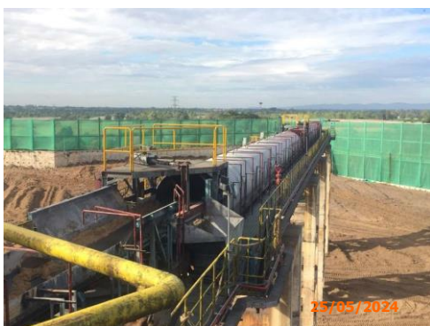
ภาพที่ 2-3 ระบบสายพานลำเลียงระบบปิด
