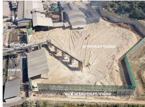
ภาพที่ 2-66 การติดตั้งครอบกันฝุ่นบริเวณลานกองกากอ้อย
